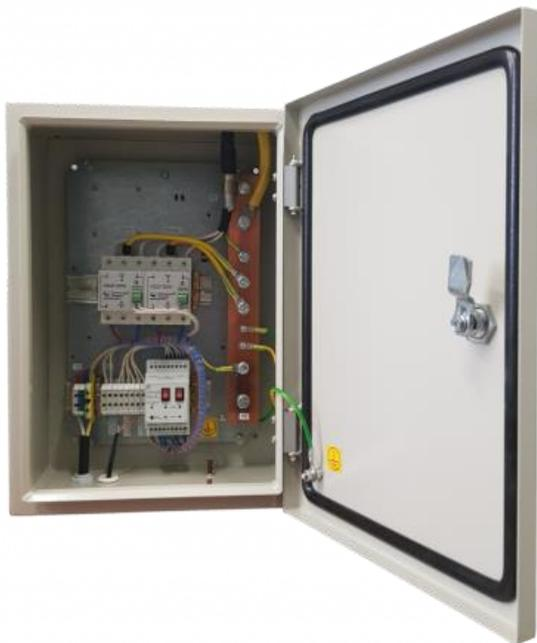
Блок управления заградительными огнями серии LEDZOM в исполнении 2×48-2×48, применяется в решениях, где требуется повышенная надежность от перенапряжения и грозозащита. Данное исполнение, позволяет использовать шкаф как блок управления и защиты (аналогично работе устройства УЗК-СОМ мод.В), а так же, исключив контроллер, можно использовать в качестве ЩЗИП (Щит защиты от импульсных перенапряжений).
