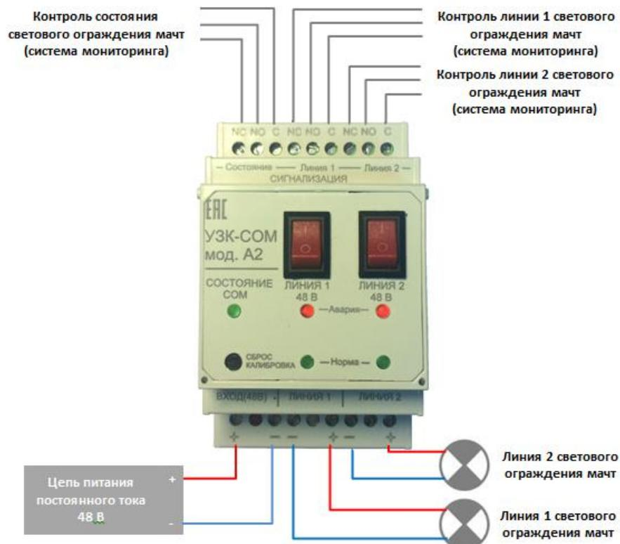
Рисунок 6. Принципиальная схема подключения УЗК-СОМ мод. А2
