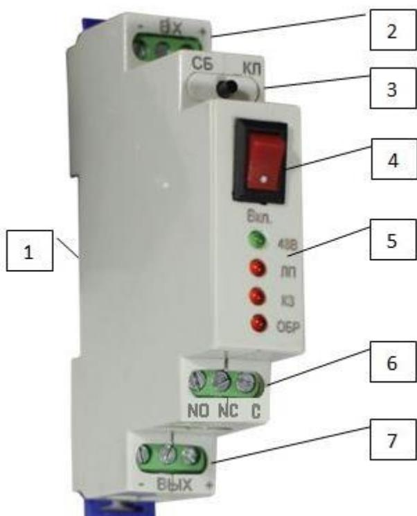
1. Корпус устройства (крепится на DIN рейку).
